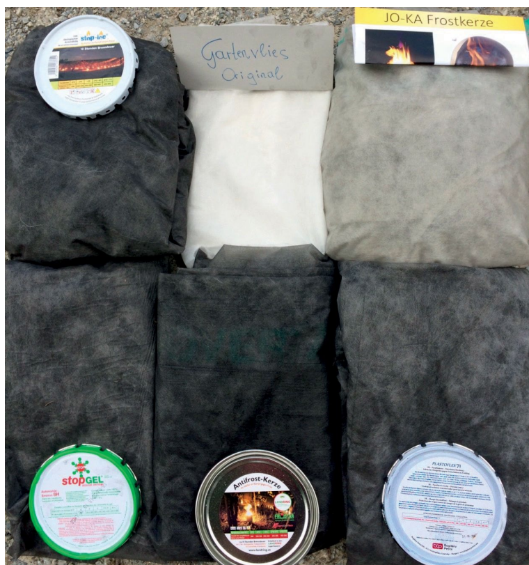
Vergleich der Rußentwicklung der einzelnen Fabrikate nach 6h Brenndauer
