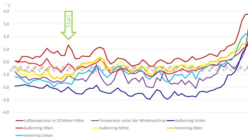
Temperaturverlauf in Abhängigkeit von der Position (Messdaten vom 22.03.2019)
